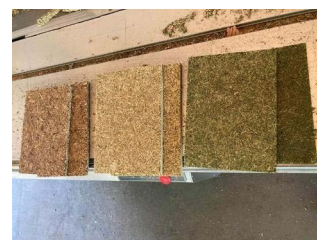
Trois panneaux de particules, de gauche à droite, en Fibre de bois, en Fibre de tige de tomate, en Fibre de tige de concombre
